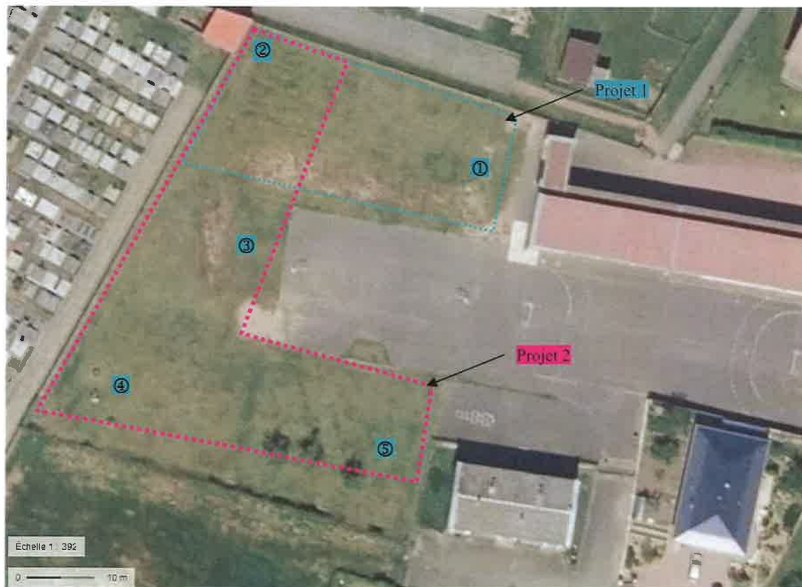
Localisation des sondages réalisés
